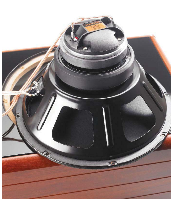
Der stark trichterförmige Konus verleiht dem Koaxtreiber eine sehr große Bautiefe. Oben ragt der Magnet des Hochtöners hervor.
