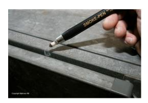
El lapicero de humo trabaja como una pluma mecánica. Tiene una mecha patentada introducida apropiadamente dentro del lapicero, la mecha es ajustable con medidas que van desde 10mm hasta 3/8" de exposición de la llama. La mecha se enciende con un mechero o con una caja de cerillas.
