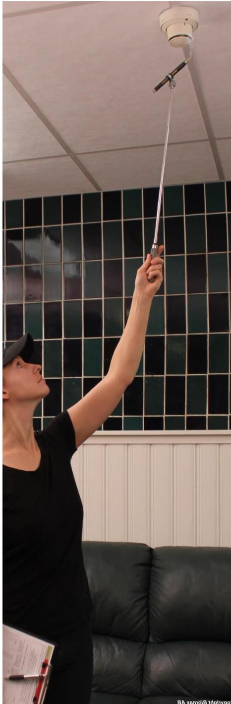
A veces se requiere de una extensión para alcanzar entradas y salidas de ventilación en los lugares más alto, detectores de humo o incluso en los lugares más bajos como pruebas de fugas en tanques o tuberías. Esta herramienta puede alcanzar una extensión de 600 mm (27").
