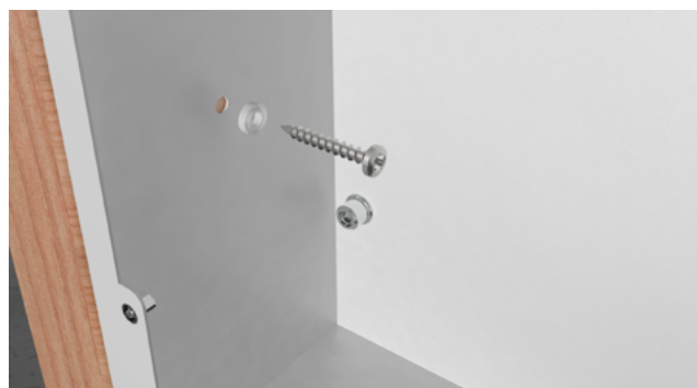
Infästning av skåp i regelvägg
