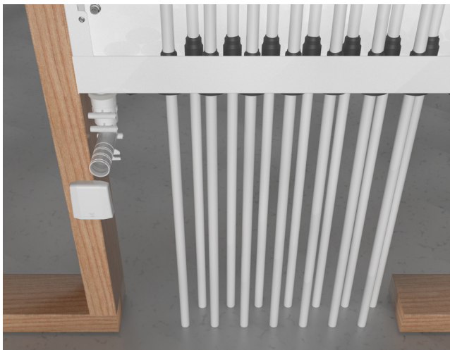
Dränagebøj direktansluten mot skåpets utloppsstos
