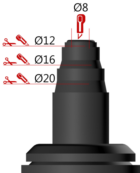
Kapning av rör genomföring.
