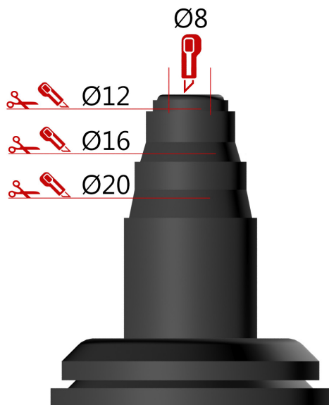
Kapning av rör genomföring.
