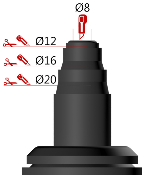
Kapning av rör genomföring.
