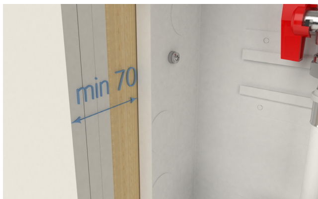
Min 70 mm från utsida gips till framkant skåp
